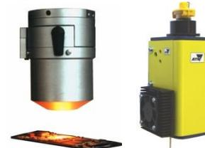
라이트 솔더링 장치 LightBeam 의 경우 컨버전스 미러와 광학 기계를 사용하여 IR-라이트를 연결합니다. 열복사의 흡수를 통해 납땜 위치에 필요한 열이 발생합니다. 출력을 컨트롤하여 정확하게 조절합니다. 그 결과 라이트 솔더링은 특히 "선택적 리플로우 솔더링"에 적합하게 됩니다.
