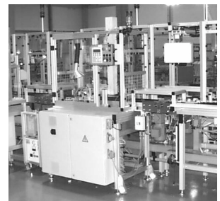
vollautomatisches Lötmodul mit Mikroflamme als Teil einer Montageanlage für Handyverstärker
