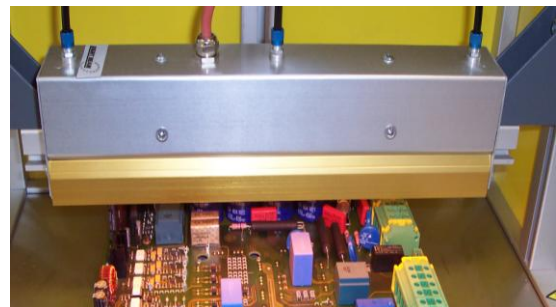
Vorwärmen und Aktivieren von Flussmittel
