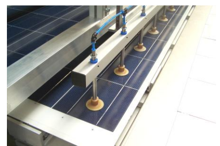
Sauggreifer an nachgiebigen Ausgleichselementen
