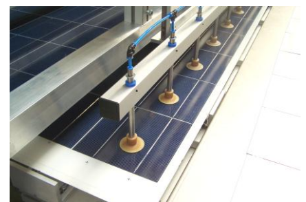
Sauggreifer an nachgiebigen Ausgleichselementen
