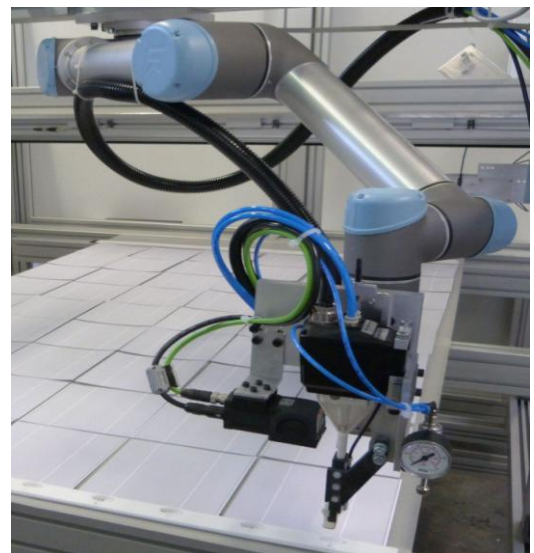
Positionierung mit Vision (alternativ: Konturschablone)
