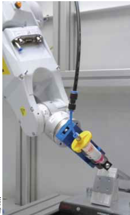
Bild 3: Das Dosieren der Lotpaste erfolgt an geeigneten Flächen.
