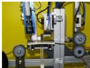
Löteinheit mit Spindeldosierventil (links) für Lotpaste, Sauggreifer (oben) zum Bestücken, Induktor (unten) und Antriebseinheit (rechts)
